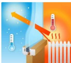
La rigidité des profilés aluminium permet des fenêtres avec des montants très fins ce qui optimise la surface vitrée et génère des apports solaires et lumineux qui réduisent les consommations de chauffage et d'éclairage.
