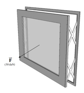
Cet effort ne doit pas engendrer au vantail de déformation résiduelle qui nuise à son fonctionnement. Après l'essai, le dispositif d'arrêt ne doit pas être détérioré\*.
