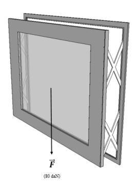
Note : Lorsque la traverse basse de l'ouvrant se situe à moins de 45cm du sol fini avec la possibilité de marcher dessus, la charge de 40 daN est augmentée à 80 daN.
